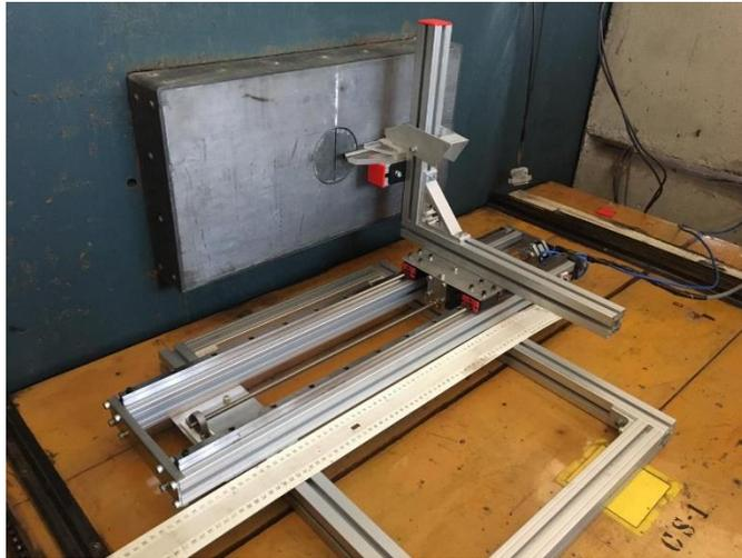
Figura 2. Esquema de montagem do equipamento de varredura gamma scanner.
