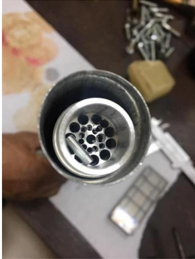
Figura 1. Esquema de montagem da fonte de cobalto - visão superior da peça.
